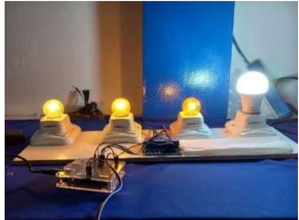
Gambar 5 Tampilan Kontrol lampu menggunakan android
