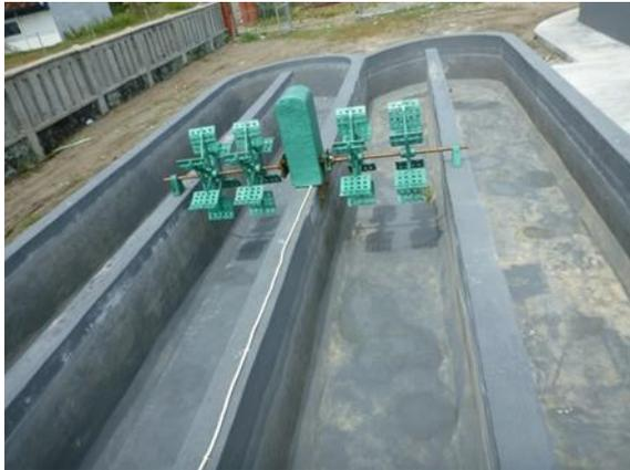
Gambar 2. Media Kultivasi (Kolam Open raceway ponds) yang telah dibersihkan
