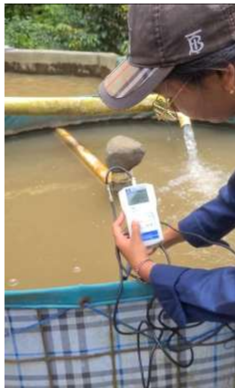
Gambar 4. Pengecekan kadar oksigen terlarut pada kolam pembenihan ikan nila.
